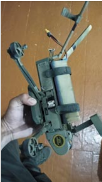
Рис. 1. Управляемый через SIM-карту БПЛА
