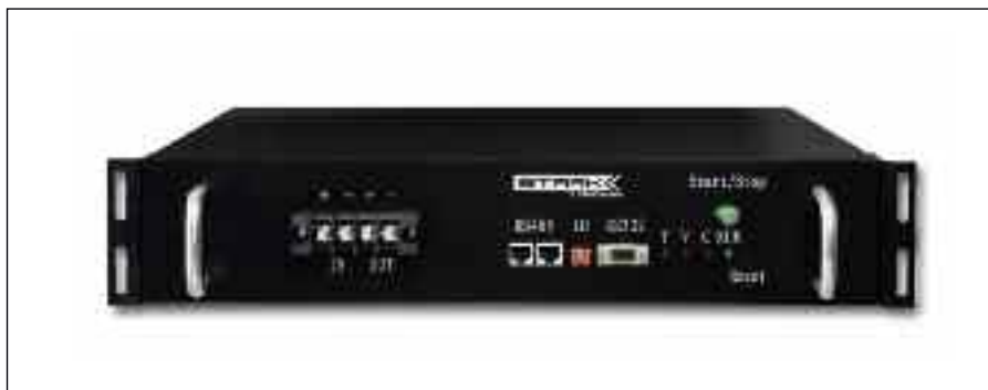
Рис. 3. Литий-ионный аккумулятор ШТАРК ЛИА
